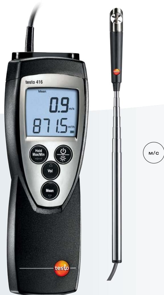
Компактный анемометр testo 416 со стационарно подсоединенным зондом-крыльчаткой. Благодаря наличию телескопической рукоятки (макс. длина до 890 мм) прибор идеально подходит для измерения скорости потока в воздуховодах. Показания объемного расхода выводятся на дисплей прибора. Для точного расчета объемного расхода в анемометр вводятся данные площади поперечного сечения воздуховода для расчета объемного расхода.
