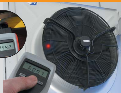
testo 465 и testo 470, бесконтактное (оптическое) измерение кол-ва об/мин на вращающихся частях
