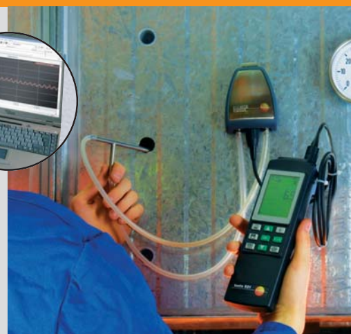
Измерения с помощью трубки Пито и внешнего зонда давления 100 Па
