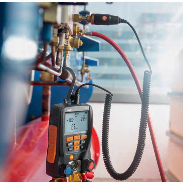
Высокоточное измерение вакуума: testo 557 с внешним зондом
