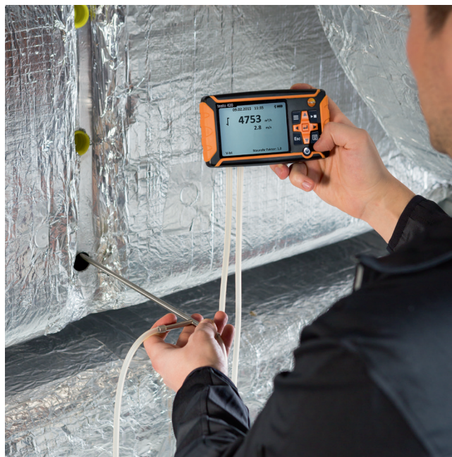
Съемная конструкция измерительного прибора позволяет проводить измерения в воздуховодах с помощью трубки Пито (трубка Пито доступна в качестве дополнительной принадлежности).
